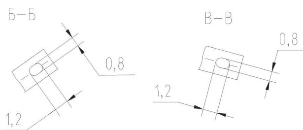
1. Материал магнитопроводов статора и ротора — сплав 36КНМ ГОСТ 10994-74, материал лепестков — латунь Л63 ГОСТ 15527-2004, покрытие лепестков О-С (61) 12 ГОСТ 9.303-84.
