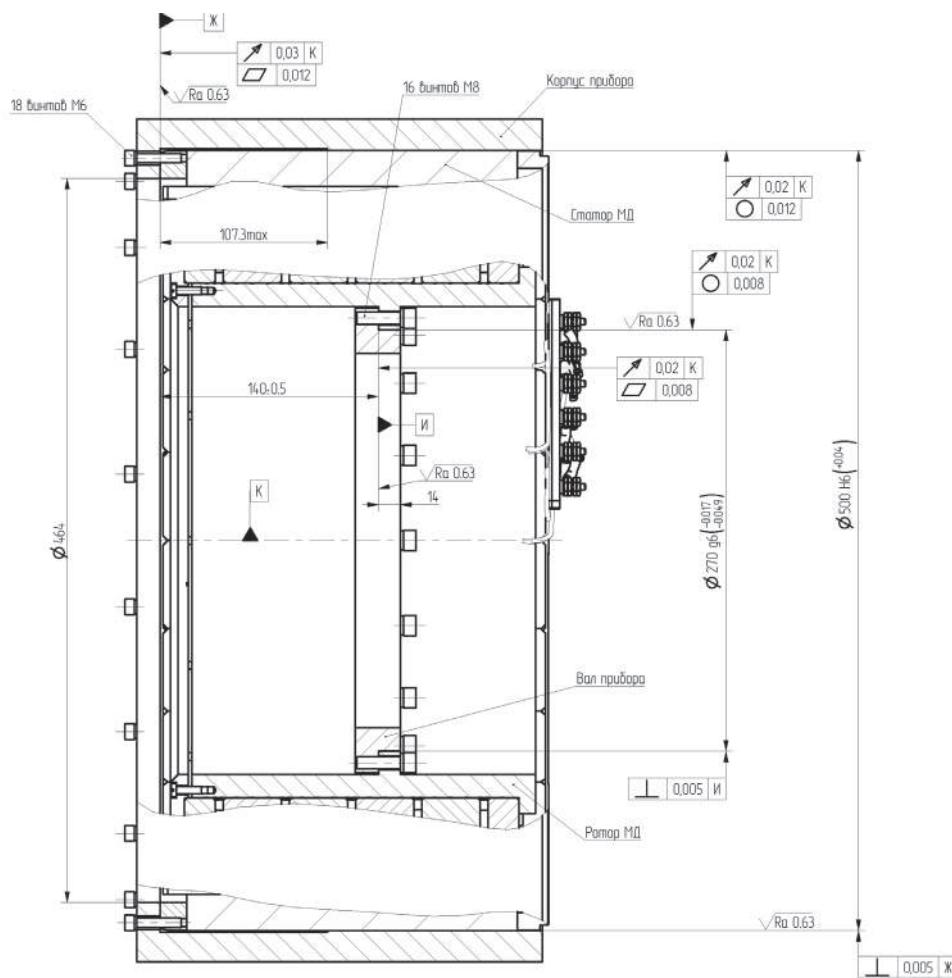
1. Материал втулки ротора и колец статора – сплав ВТ1-0 ГОСТ 90013-81, статора – сталь 10860 ГОСТ 11036-75 с покрытием Ц6.хр; материал наконечников – латунь Л63 ГОСТ 15527-2004, покрытие наконечников Н3.0-С(50)3 ГОСТ 9.303-84.
