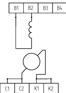
1. Материал магнитопроводов статора и ротора — сталь 10860 ГОСТ 11036-75 с покрытием Ц9.хр., материал лепестков — латунь Л63 ГОСТ 15527-2004, покрытие лепестков Н3. О-С (60) 6 ГОСТ 9.303-84.
