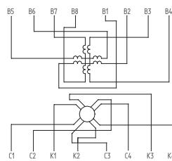
1. Материал магнитопроводов статора и ротора – сплав 50Н ГОСТ 10160-75.
