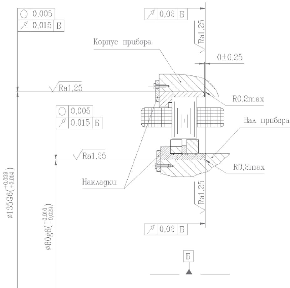
1. Материал корпуса статора — сталь А25Х13Н2П ГОСТ 5632-2014, материал втулки ротора — ВТ1-0 ОСТ1.90013-81, материал лепестков — латунь Л63 ГОСТ 15527-2004, покрытие лепестков Н3.0-С (60) 6 ГОСТ 9.303-84.
