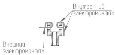
1. Материал корпуса статора и втулки ротора — сплав ВТ1-0 ГОСТ 1.90013-81, материал лепестков — латунь Л63 ГОСТ 15527-2004, покрытие лепестков Н3.0-С (60) 6 ГОСТ 9.303-84.
