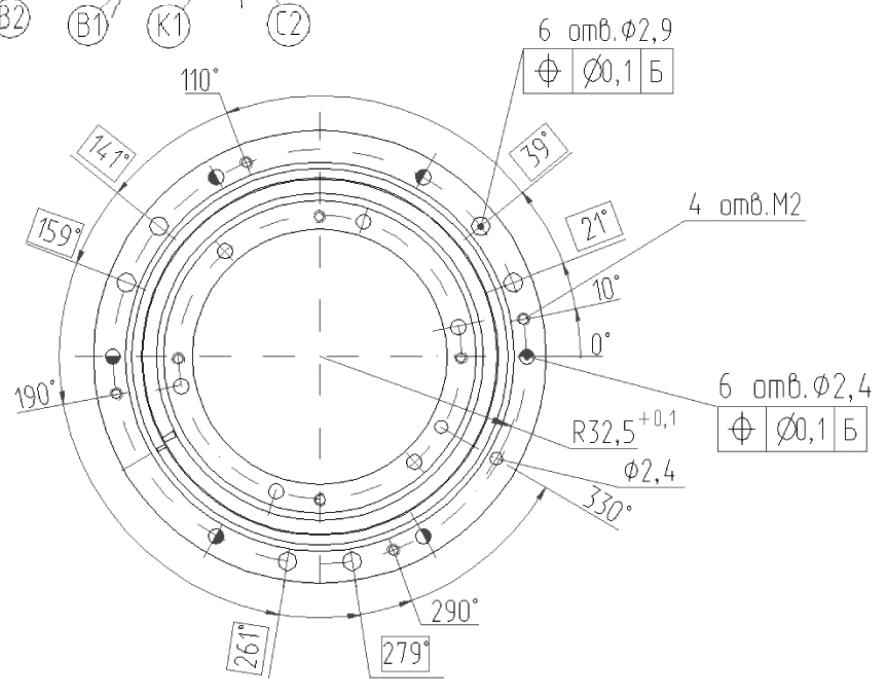
1. Материал магнитопроводов статора и ротора — сплав 36КНМ ГОСТ 10994-74.
