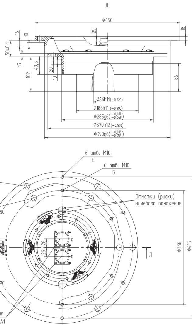
1. Материал посадочных поверхностей статора и ротора — сталь А25Х13Н2П ГОСТ 5632-2014.
