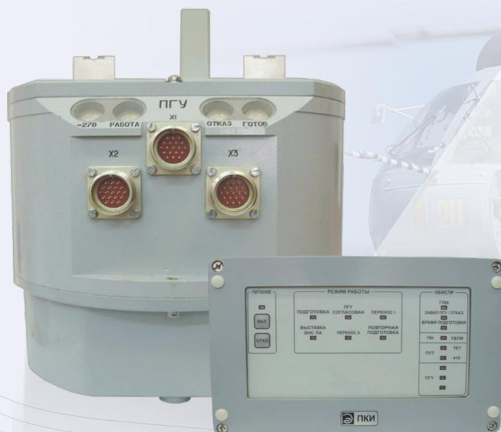
Гироскопическое устройство выставки курса ГУВК должно получать информацию об углах бортовой и килевой качки, географических координатах места, составляющих линейной скорости движения корабля относительно грунта, а так же о курсе корабля от корабельной системы инерциальной навигации и стабилизации или навигационного комплекса.
