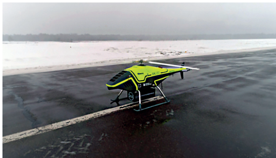
Рис. 4. Беспилотный летательный аппарат (БАС-200) с прикрепленным бескарданным аэрогравиметром (фото ГНПП «Аэрогеофизика»)
