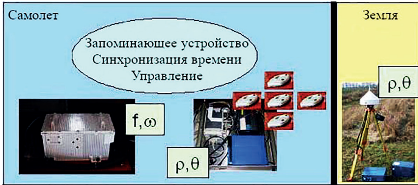
Рис. 2. Компоненты аэрогравиметра на базе ИИМ SAGEM Sigma 30 [78]: f – кажущиеся ускорения, \omega – угловая скорость, \rho – координаты, \theta – углы ориентации ЛА
