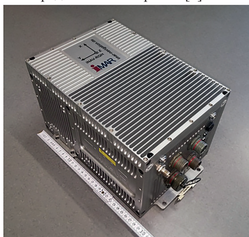
Рис. 7. Внешний вид и составные части гравиметра на базе ИИМ iNAV-RQH-1003 (показаны только значимые компоненты) [9]
