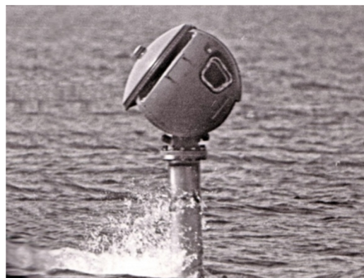
Рис. 3. Перископный радиосекстан во время обсервации
