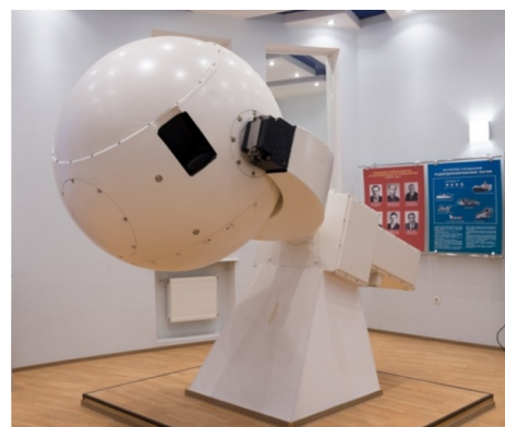
Рис. 2. Станция определения смещения центра радиоизлучения Солнца «Дрейф»
