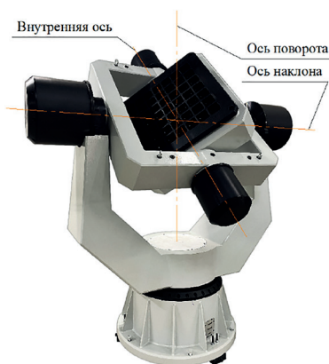
Рис. 1. Трехосный поворотный стенд СТА-10
