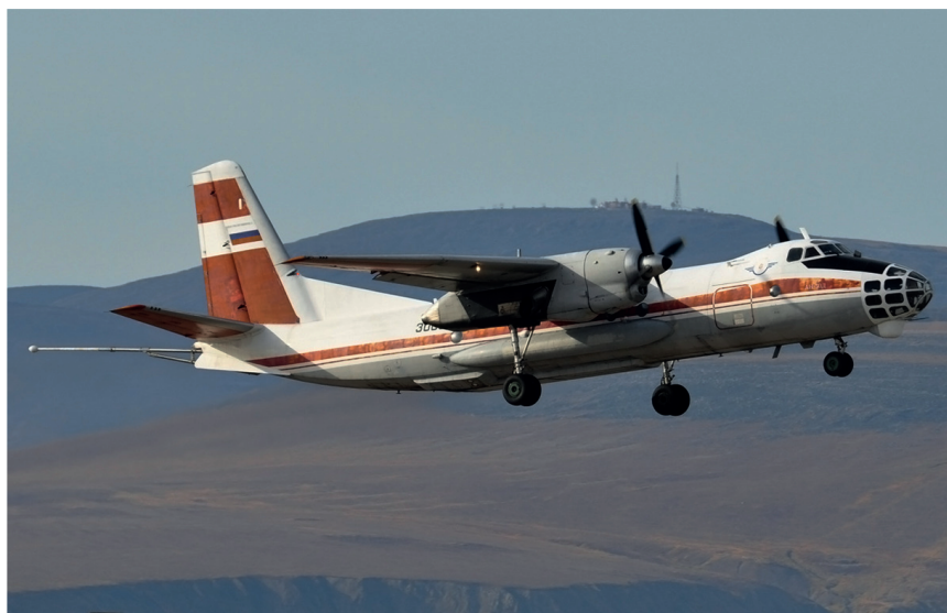
Рис. 6. Летающая лаборатория на базе АН-30Д для съемки параметров МПЗ с установленными датчиками магнитометров в немагнитном стингере в хвосте самолета
