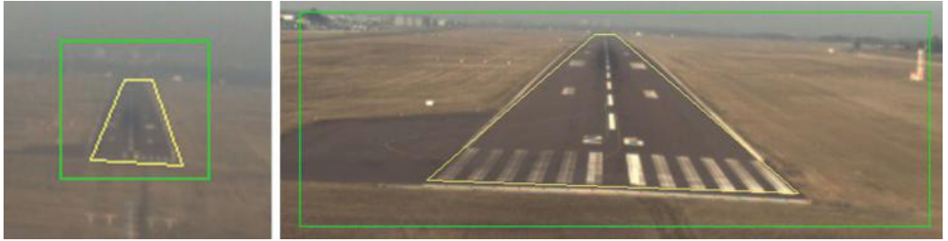
Рис. 4. Модель предполагаемой ВПП (желтый контур); зона внимания вокруг модели ВПП (зеленый контур)
