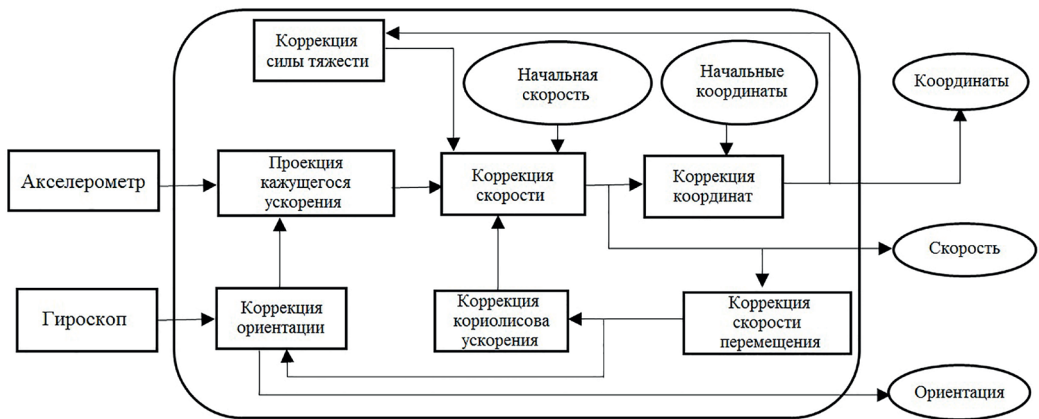
Рис. 6. Схема бесплатформенной инерциальной навигационной системы (БИНС) [20]
