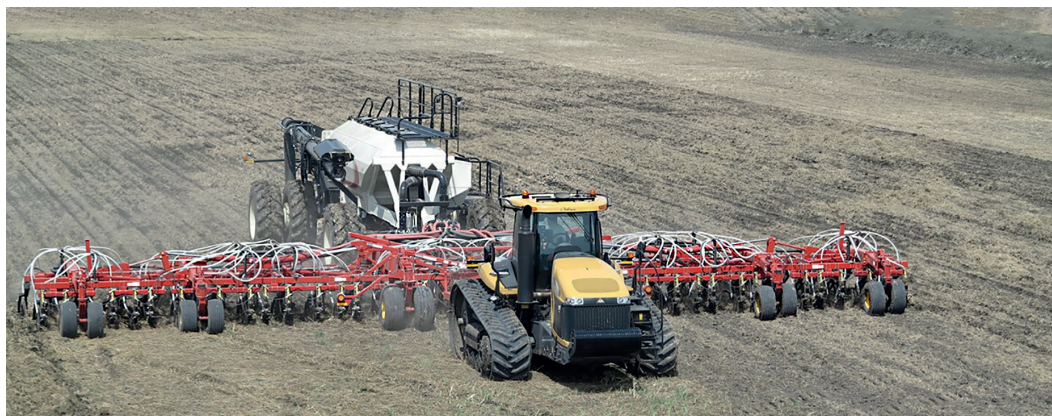
Рис. 1. Сельскохозяйственный робот. В кабине присутствует оператор, следящий за безопасностью выполнения работ. Руление и управление навесным оборудованием выполняется автоматически
