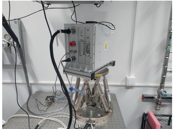
Рис. 12. Схема установки для измерений в помещении. ИИМ на КЛГ iMAR и МЭМС ИИМ Lord Microstrain (черного цвета) помещены на гексапode. Оба датчика подсоединены к одному разветвителю ГНСС-антенны (рядом с гексаподом), что обеспечивает временную синхронизацию датчиков
