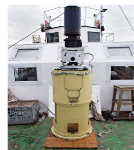
Рис. 8. Макет гиросtabilизированного зенитного телескопа на судне
