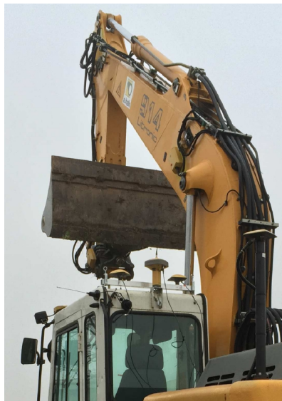
Рис. 10. Размещение двухантенной системы на кабине экскаватора
