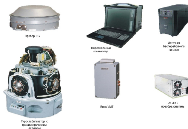
Рис. 2. Мобильный гравиметр «Чекан-АМ»
