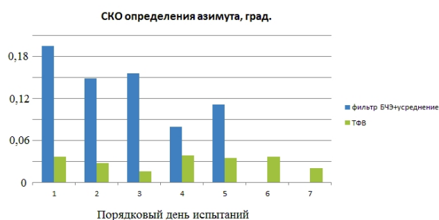
Рис.6. Обобщенные результаты испытаний ТФВ с использованием БИНС на шасси наземного подвижного объекта
