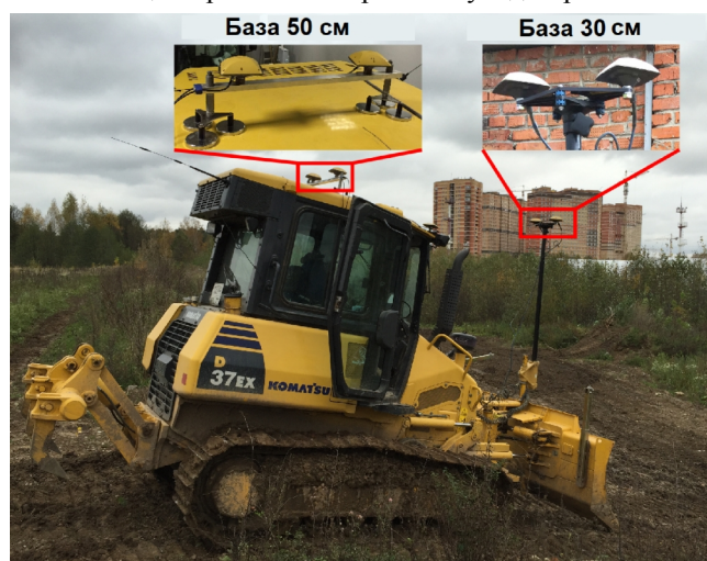
Рис. 13. Размещение антенных пар на бульдозере
