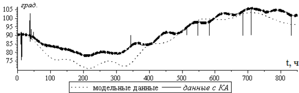
Рис. 9. Угол между векторами кинетического момента полярного и экваториального гироскопов
