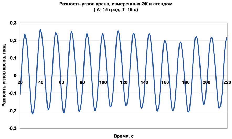
Рис. 5. Разность значений углов крена, выработанных ЭКД и стендом
