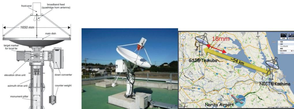
Рис. 1. Приемная антенна РСДБ-пункта диаметром 1,6 м системы «MARBLE»
