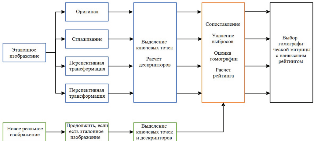
Рис. 4. Алгоритм сопоставления с моделями изображений: на каждом из четырех разных вариантов эталонного изображения выделяются ключевые точки. Четыре множества ключевых точек и дескрипторы сохраняют в памяти. При получении реальных изображений на них выделяются ключевые точки и сопоставляются отдельно с каждым из четырех множеств. После удаления выбросов производится робастная оценка методом RANSAC, в результате которой формируются четыре оценочные матрицы гомографии. По результатам ранжирования для каждой из оценок выбирают матрицу гомографии с наиболее высоким рейтингом
