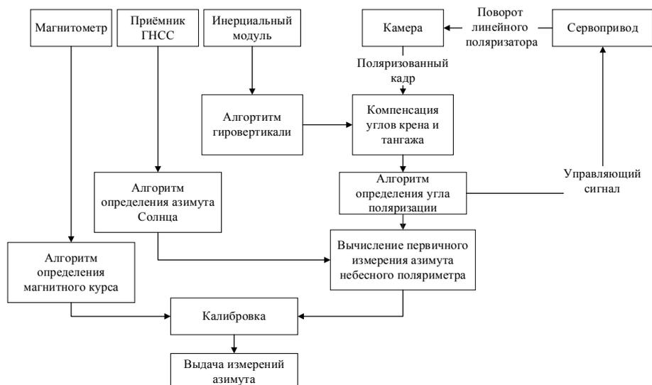
Рис. 1. Обобщённая структурная схема алгоритмического обеспечения калибровки небесного поляриметра
