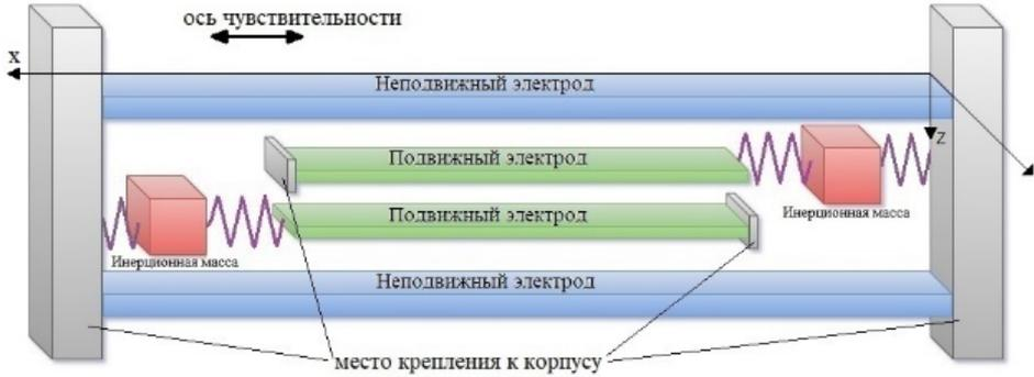
Рис. 1. Модель акселерометра
