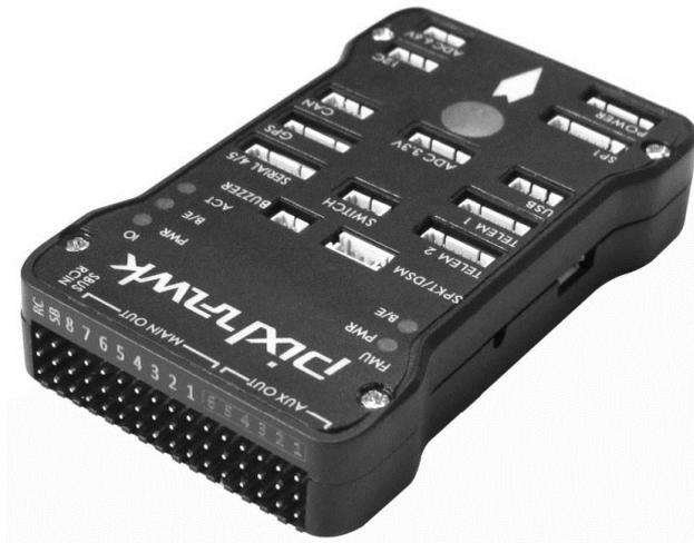
Рис.2. Полетный контроллер
