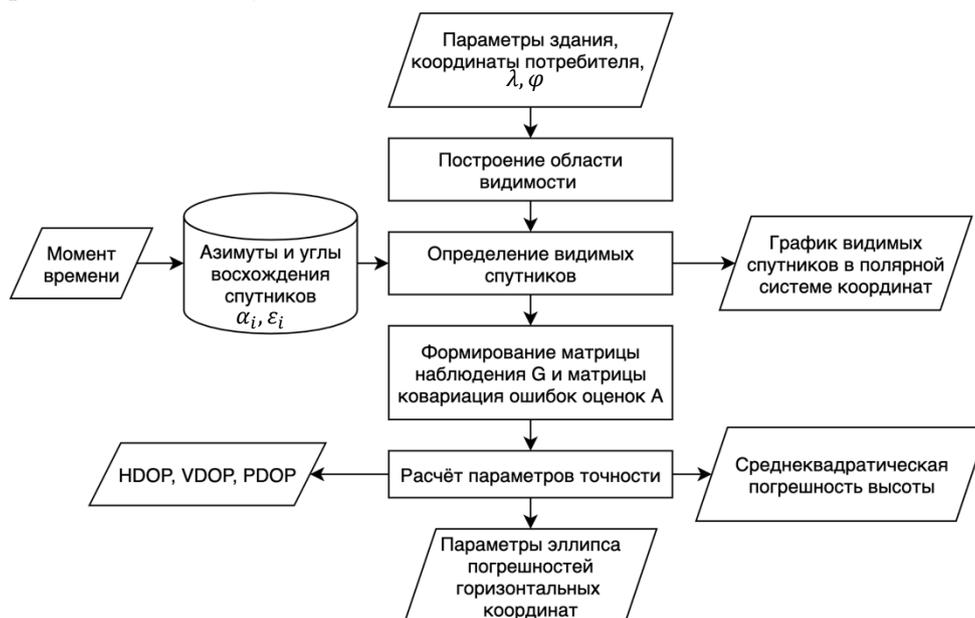
Рис. 2. Блок-схема программного обеспечения
