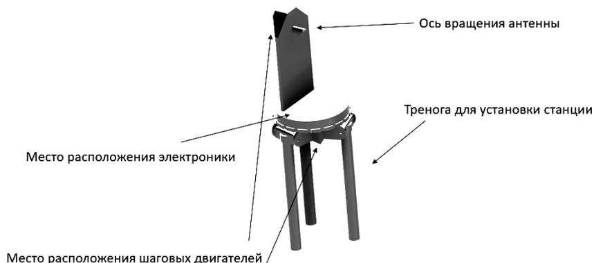
Рис 1. Модель системы наведения антенны (без шаговых двигателей)
