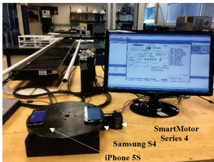
Рис. 4. Одноосный позиционно-скоростной стенд Animatics SmartMotor™, серия 4
