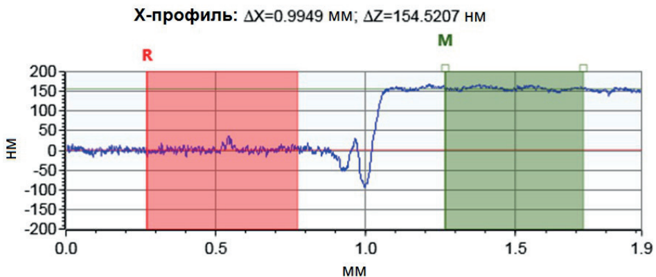
Рис. 15. Измерение толщины тонкопленочного покрытия с помощью оптического профилометра
