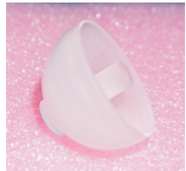
Рис. 13. Образец прецизионного гибридного резонатора с ультрафиолетовой шлифовкой поверхности
