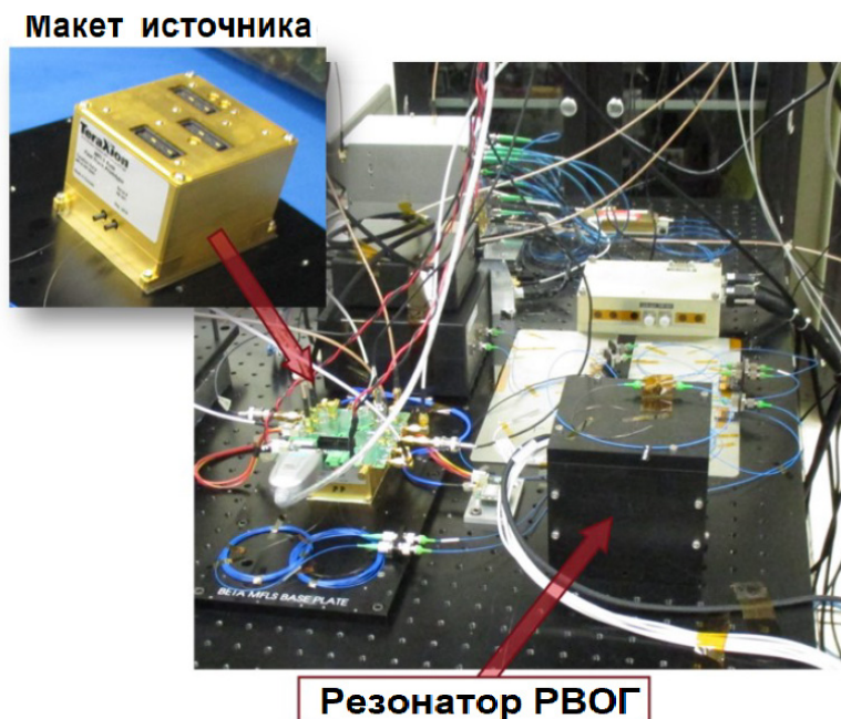
Рис. 7. Макет трехлазерного источника света на основе кремниевой фотоники и самого РВОГ [54]
