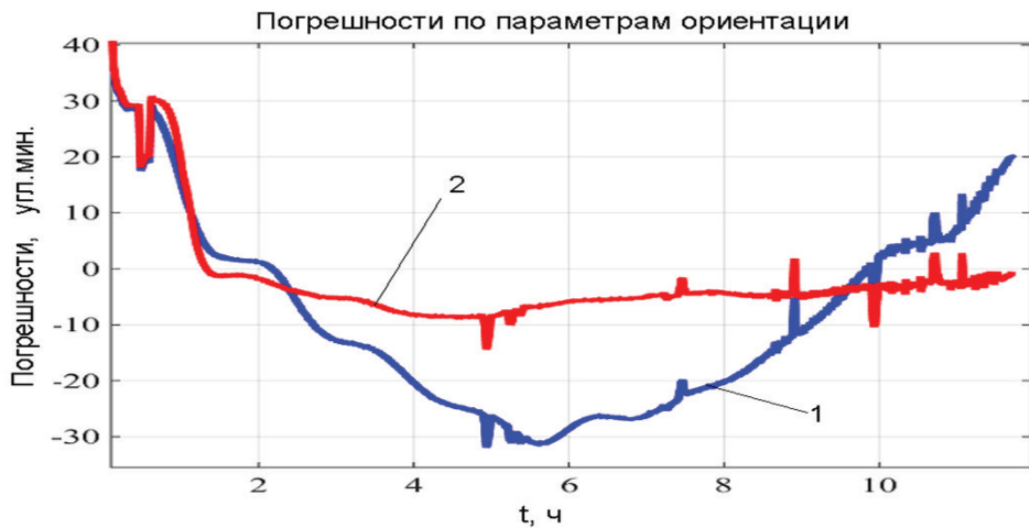
Рис. 12. Погрешности (угл. мин) БИНС по курсу: 1 – без оценивания дрейфов ВОГ и смещений нулей акселерометров, 2 – с оценкой дрейфов ВОГ и смещений нулей акселерометров
