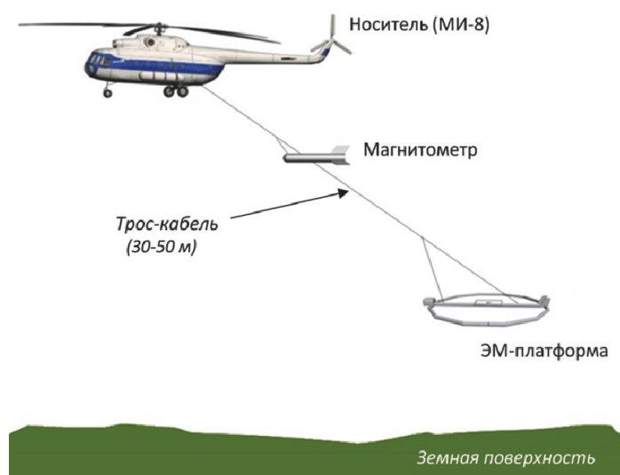
Рис. 1. Схема электромагнитного измерительного комплекса на примере «Импульс-Аэро»
