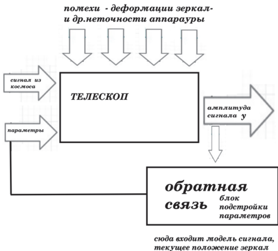
Рис. 1. Диаграмма контура адаптации углов поворотов зеркал
