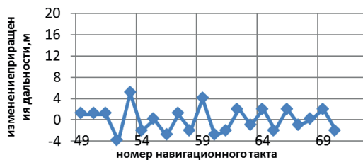
Рис. 4. Изменение приращения наклонной дальности по данным ГАНС УКБ при зависании АНПА (м)
