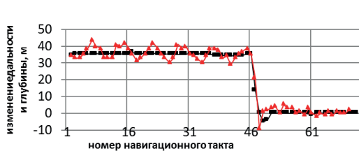
Рис. 3. Приращение наклонной дальности по данным ГАНС УКБ (красная линия) и изменение глубины по данным датчика глубины АНПА (черная линия), м
