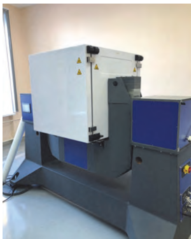
Рис. 9. Двухосный высокоточный поворотный стенд лаборатории лазерных навигационных систем МФТИ
