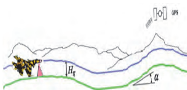
Рис. 3. Полет в режиме следования рельефу местности
