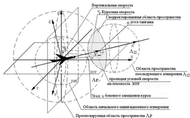
Рис. 1. Область пространства последующего навигационного измерения, скорректированная в результате ДРК
