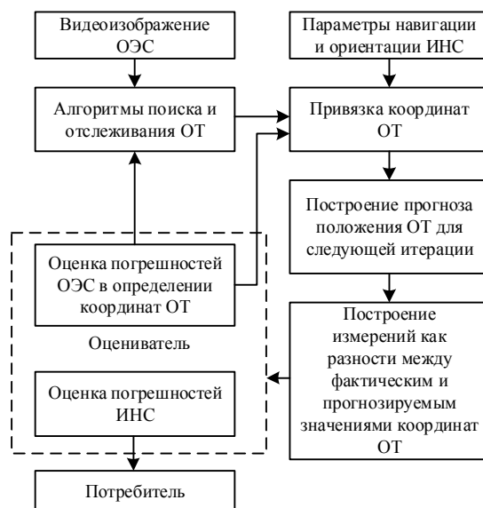
Рис. 1. Использование ОЭС в качестве корректора ИНС
