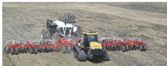
Рис. 1. Сельскохозяйственный робот. В кабине присутствует оператор, следящий за безопасностью выполнения работ. Руление и управление навесным оборудованием выполняется автоматически
