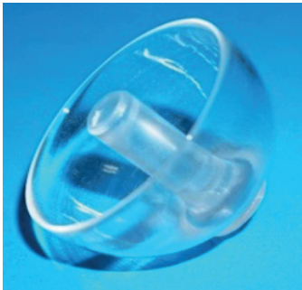
Рис. 11. Прецизионный резонатор из кварцевого стекла
