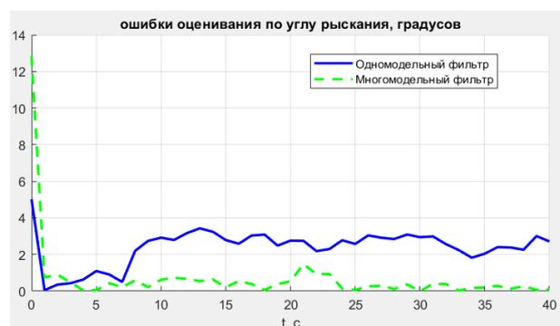
Рис. 1. Оценивание угла рыскания разными фильтрами
