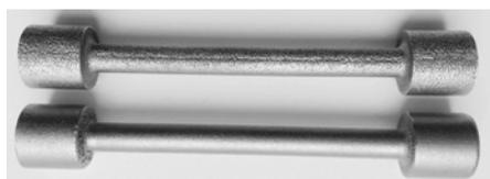
Рис 1. Исследуемые образцы, изготовленные с помощью АТ. Продольная (сверху) и поперечная (снизу) печать
