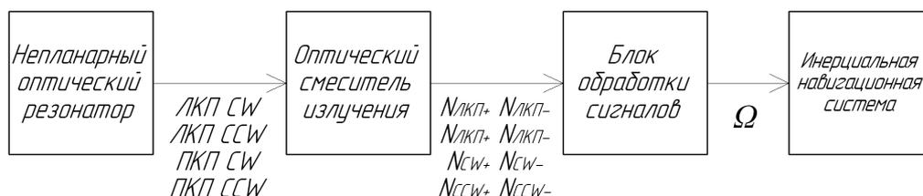
Рис. 3. Функциональная схема ЧЧЛГ; N – число импульсов биений за положительный «+» и отрицательный «-» полупериоды работы магнитооптической частотной подставки, СВ – направление распространения волн по часовой стрелке, ССВ – направление распространения волн против часовой стрелки
