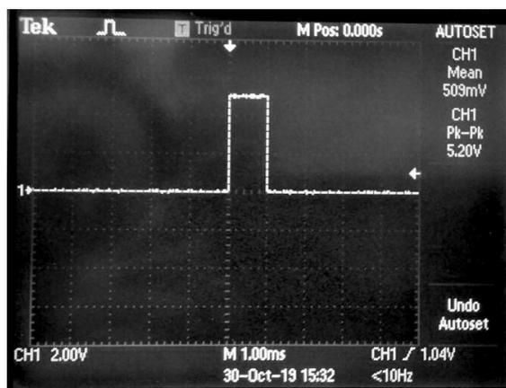
Рис. 2 Внешний вид ТТЛ импульса
