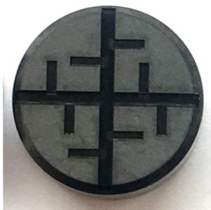
Рис.4. Вставка с профилем, полученным методом лазерной обработки
