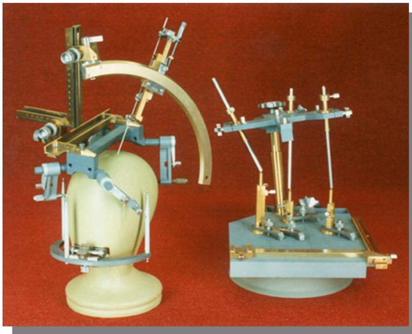
Рис.1. Механический стереотаксический манипулятор "Ореол"
