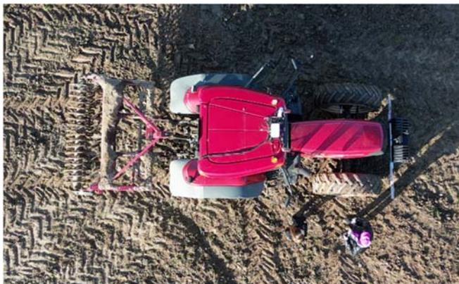
Рис. 6. Трактор, с установленным на нём МЭМС, одометром и ГНСС приёмником
