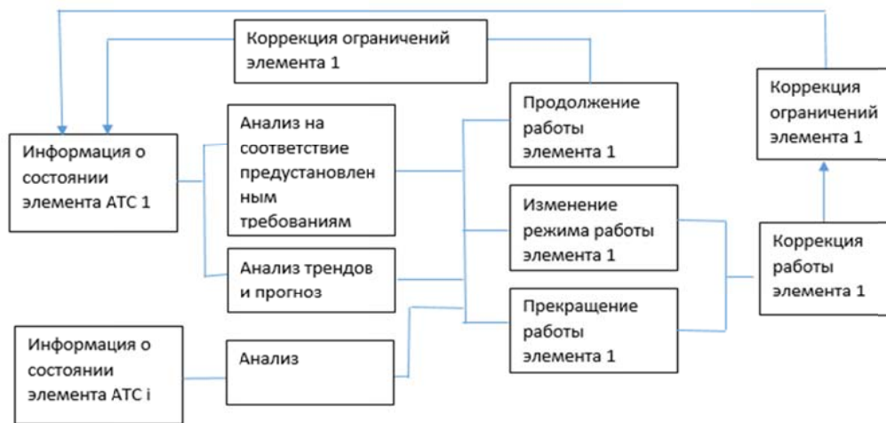
Рис. 1. Процесс индивидуального мониторинга и прогнозирования состояния отдельных элементов системы
