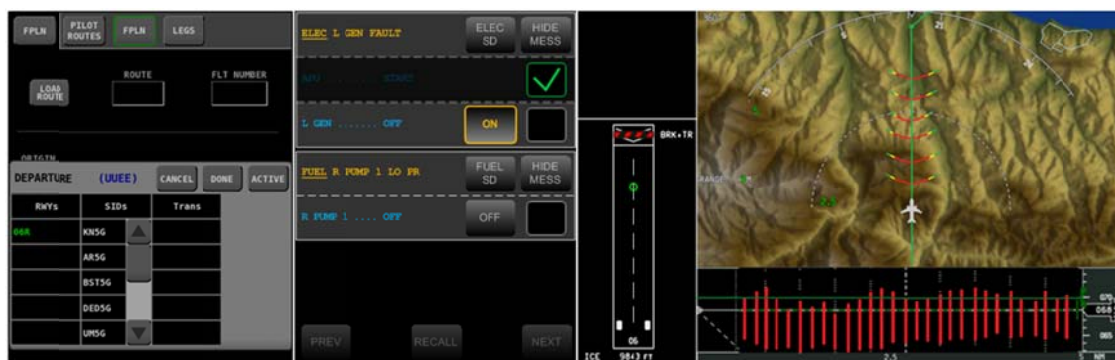
Рис. 3. Кадр системы самолётovoждения, аварийный чек-лист, кадр прогноза торможения и навигационный кадр с индикацией прогноза распространения ударной волны
