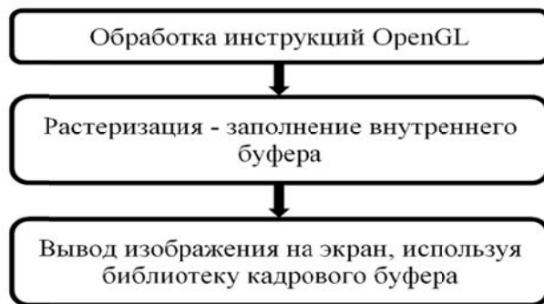
Рис. 1. Схема работы OpenGL с использованием одного ядра процессора.
