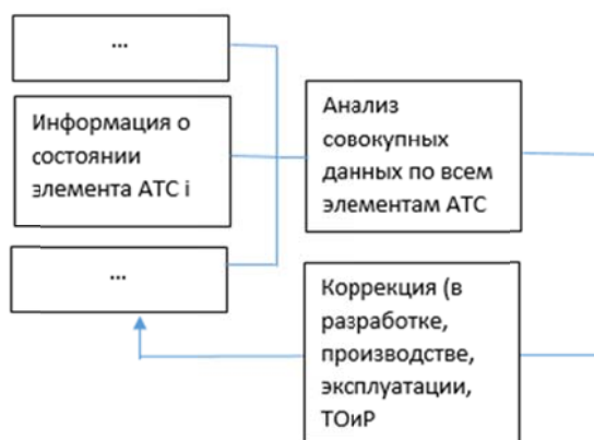
Рис. 2. Схема группового мониторинга состояния элементов системы
