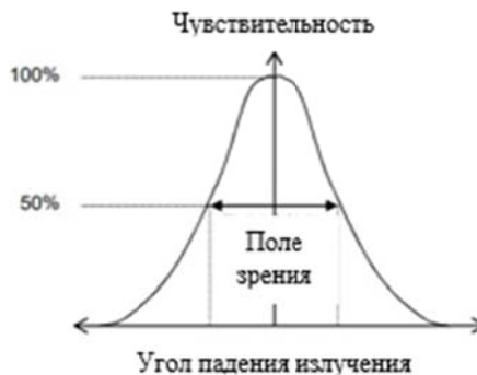
Рисунок 2. Вид зависимости чувствительности ИК-датчика от угла падения.
