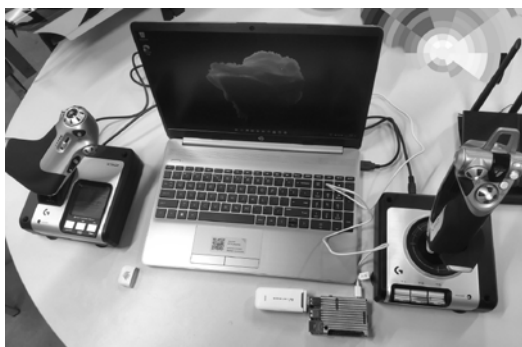
Рис. 1. Общий вид стенда отладки алгоритмов удалённого управления движением судов
