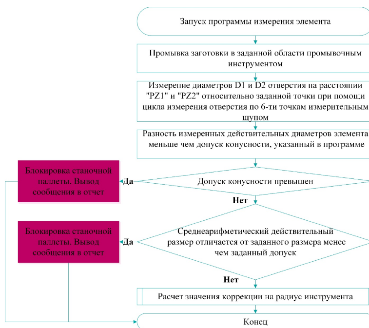
Рис. 2. Модернизированный алгоритм определения геометрических размеров обрабатываемого элемента заготовки
