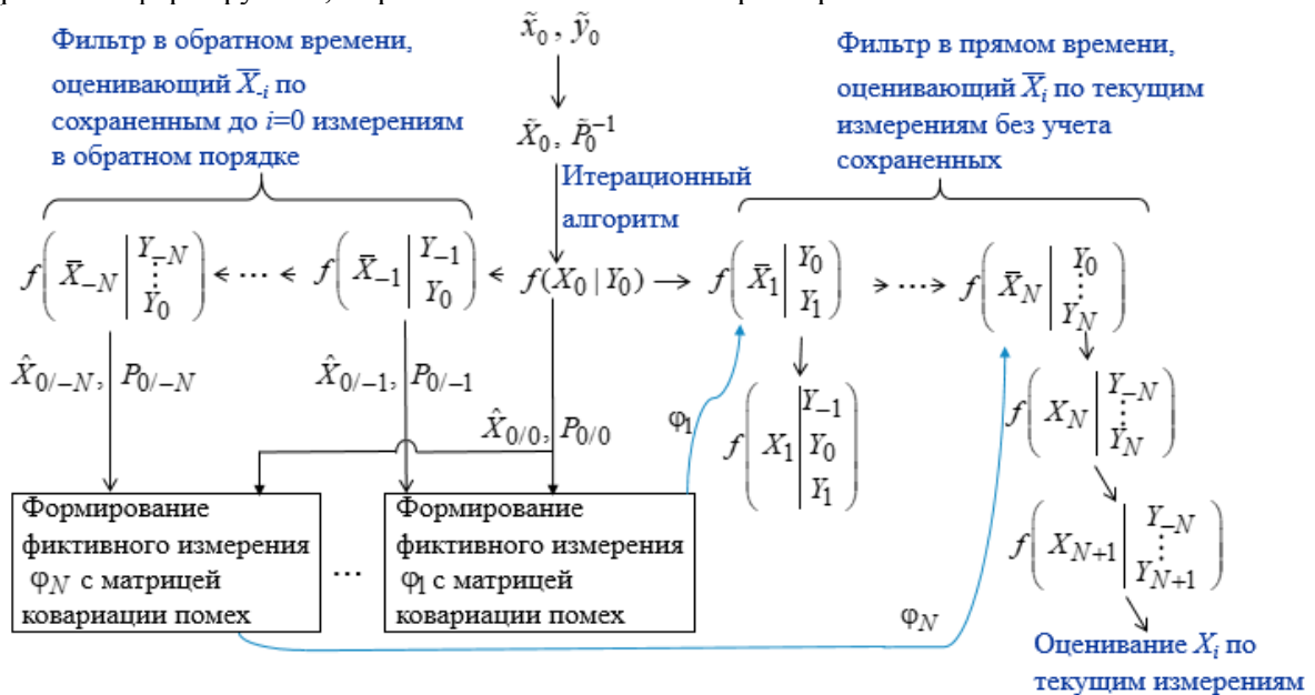
Рис. 1. Схема преобразования гауссовских аппроксимаций апостериорных плотностей при работе предложенного алгоритма. На схеме \tilde{x}_0, \tilde{y}_0 – начальная точка линеаризации, X_{0/-i}, P_{0/-i} – оценка X_0 по Y_{-i}, \dots, Y_0 и ковариационная матрица ее ошибок
