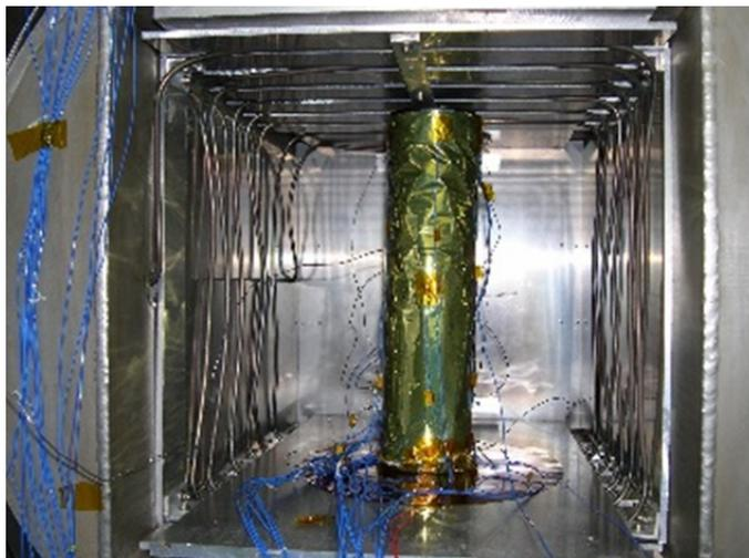
Рис. 4. Тепловые испытания трубы в вакуумной камере [11]
