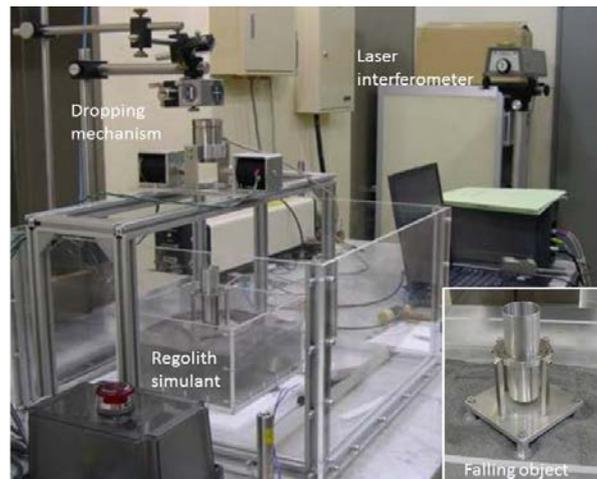
Рис. 10. Устройство для эксперимента с падением объекта на материал, имитирующий лунный грунт, и падающий объект на грунте (внизу справа).
