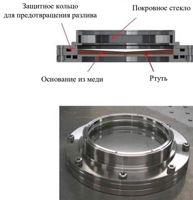
Рис. 8. Поперечный разрез ртутного горизонта, установленного в опытной модели телескопа (*вверху*), и его внешний вид (*внизу*) [17]
