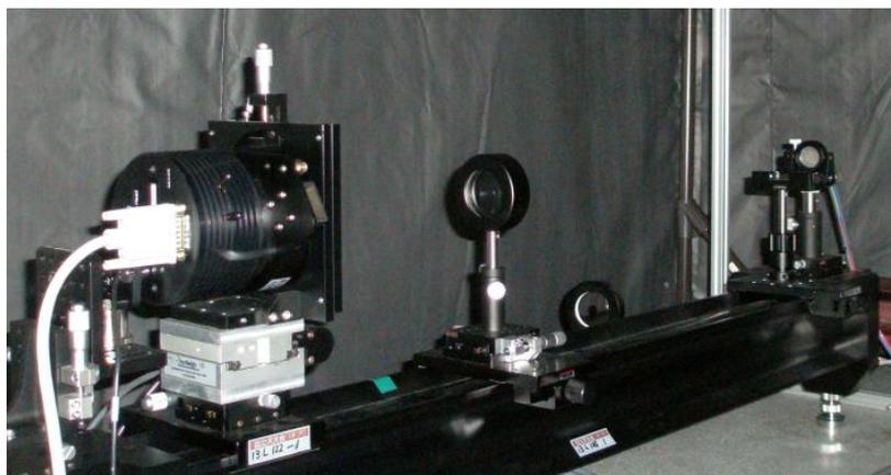
Рис. 5. Устройство для экспериментов с центроидами, включающее ПЗС-камеру, объектив и пластину с точечными отверстиями, установленную спереди на оптическом рельсе
