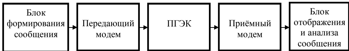
Рис.1. Структурная схема стенда для испытаний модемов гидроакустической связи
