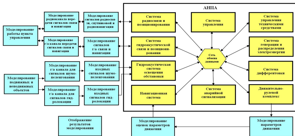
Рис. 2. Структура программного обеспечения цифрового полигона
