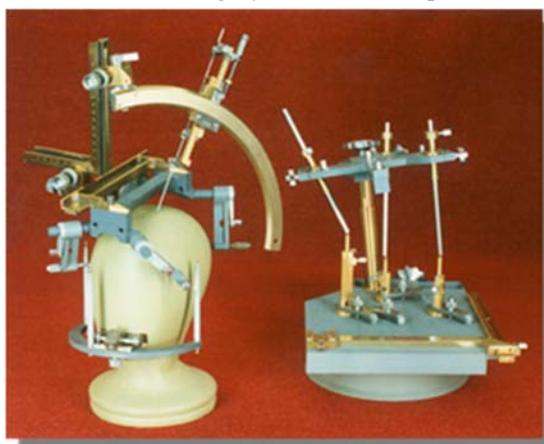
Fig. 1. The mechanical stereotactic manipulator «OREOL»
