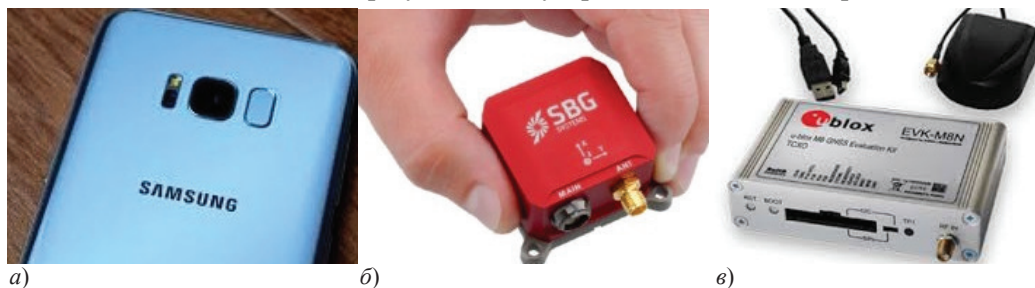
Рис. 7. Используемое оборудование: а – смартфон, б – модуль SBG, в – ГНСС-приемник u-blox
