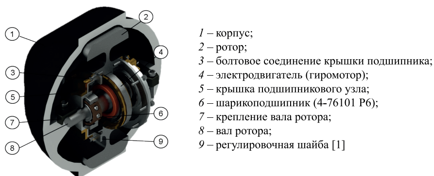
Рис. 3. Схема гироскопического устройства
