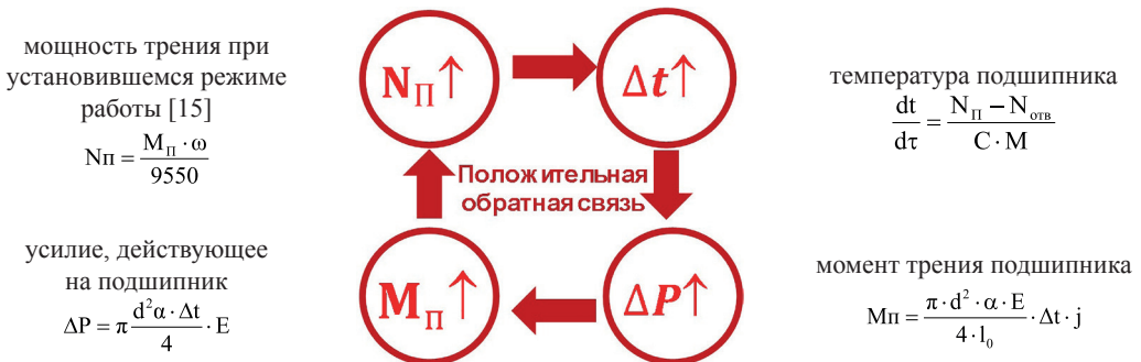
Рис. 6. Нестационарный процесс с положительной обратной связью
