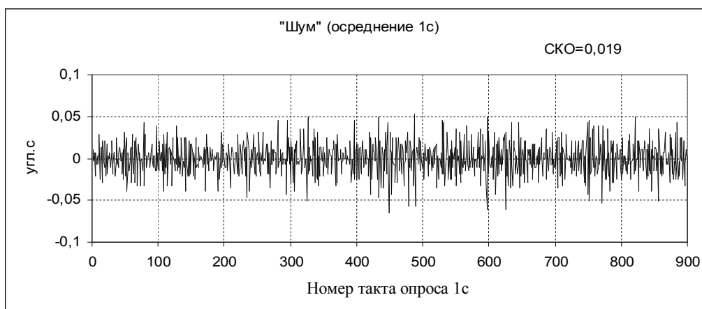
Рис. 12. Графики шумовой составляющей выходной информации с осреднением 1 с (900 точек)
