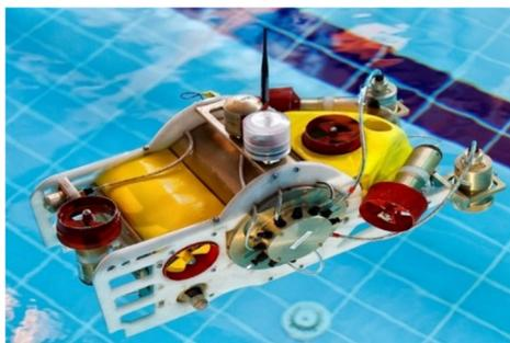
Рис. 7. Подводный аппарат с установленной стереокамерой
