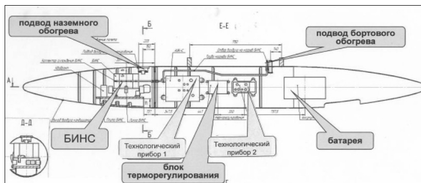
Рис. 11. Схема подвесного контейнера для испытаний БИНС в составе самолетной лаборатории
