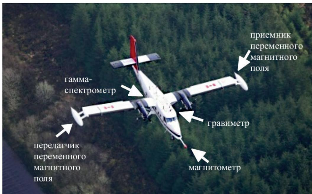
Рис. 1. Аэрогеофизический комплекс фирмы Sander Geophysics, включающий аэромагнитометрию, аэрогравиметрию, аэроэлектроразведку, аэрогамма-спектрометрию
