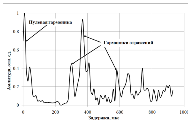
Рис. 2. Кепстр, построенный из передаточного импеданса, измеренного в реверберационном поле
