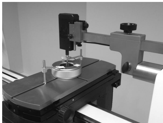
Рис. 3. Измерение внутреннего диаметра кольца на эталоне ВНИИМ с использованием патрона для установки контактного щупа со сферическим наконечником
