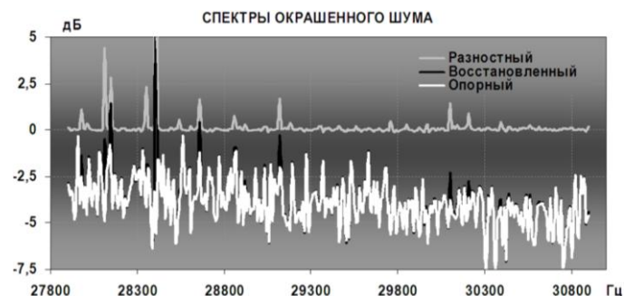
Рис. 6. Опорный, восстановленный и разностный спектры окрашенного шума
