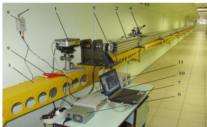
Рис. 1. Внешний вид компаратора (1 – система лазерная измерительная XL-80; 2 – направляющие; 3 – основание; 4 – каретка; 5 – узел привода каретки с шаговым двигателем; 6 – блок питания шагового двигателя; 7 – блок управления шаговым двигателем; 8 – приемник радиосигнала; 9 – модуль видеозахвата; 10 – система обработки изображения; 11 – блок измерений температуры)
