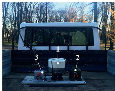
Рис. 8. Размещение аппаратуры на общем основании в кузове автомобиля: 1 – ГНСС-компас «Орион-М», 2 – ИМ, 3 – эталонная БИНС на ВОГ (по данным [33])
