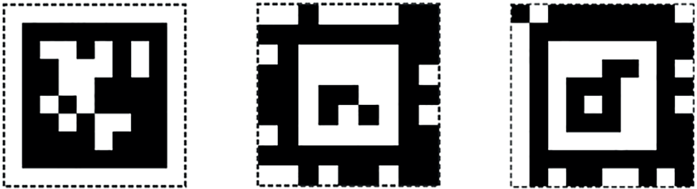
Рис. 2. Примеры маркеров (белым цветом выделены светоотражающие участки, черным – светопоглощающие)
