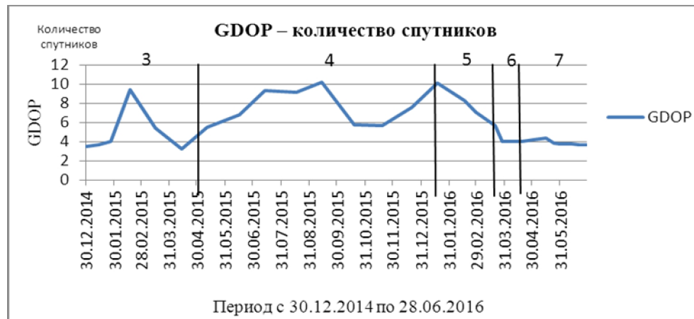
Рис. 5. Сравнение GDOP и количества спутников IRNSS с 30.12.2014 по 28.06.2016
