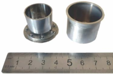
Рис. 1. Внешний вид волнового твердотельного гироскопа с металлическим резонатором (чувствительный элемент)
