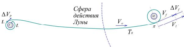
Рис. 5. Схема одноимпульсного перехода КА на высокую круговую орбиту ИСЛ
