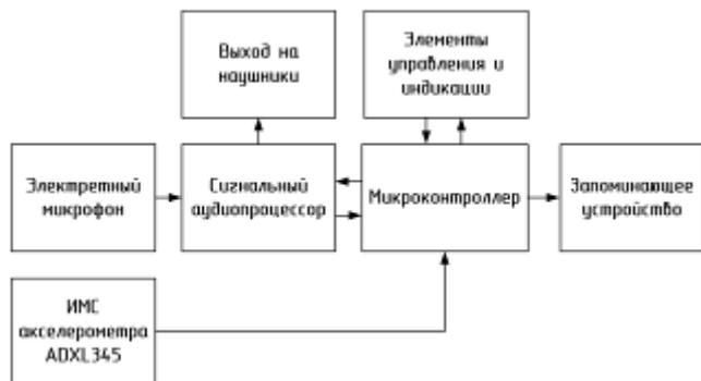
Рис. 1. Структурная схема инерциально-акустической системы электронной аускультации
