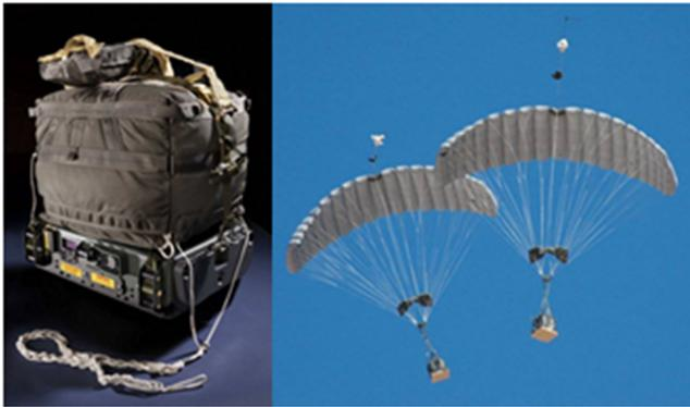
Рис. 2 Многоэтажная система серии JPADS в уложенном виде [2] и в полете [4]
