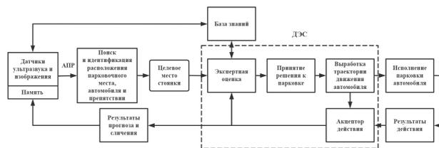
Рис. 4. Структура интеллектуальной системы парковки автомобиля: АПР – алгоритм поиска и идентификации расположения объекта
