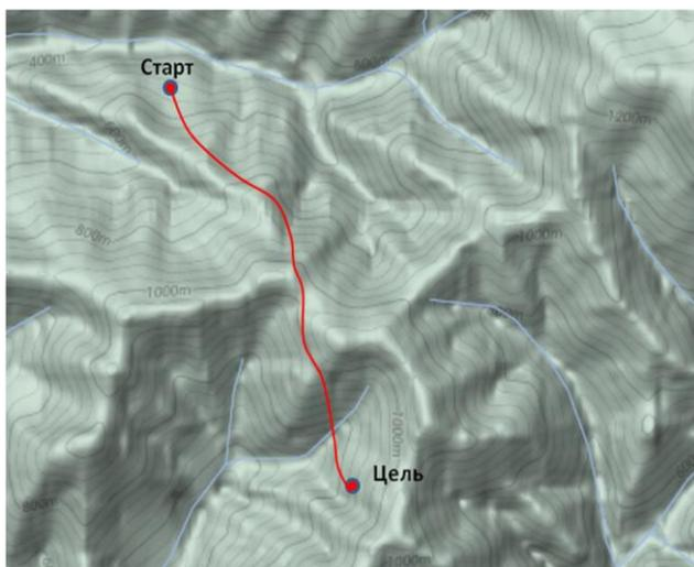
Рис. 4 - Результат формирования низковысотной траектории БПЛА при движении через возвышенности
