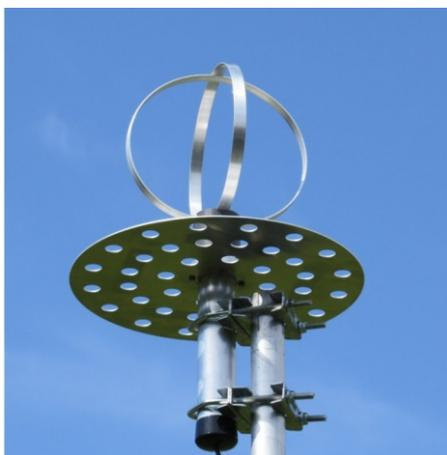
Рис. 1. Пример антенны для приема и передачи информации с МКС и на МКС во время теста №1
