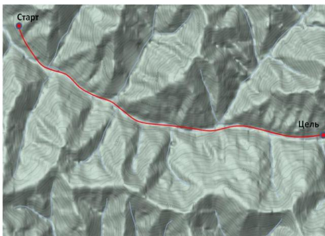
Рис. 3 – Результат формирования низковысотной траектории БПЛА, преимущественно над ложбинами рельефа местности
