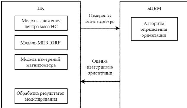
Рис. 6. Программно-аппаратное моделирование работы алгоритма
