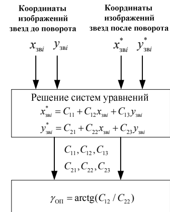
Рис. 3. Блок-схема определения угла поворота СК ФПУ
