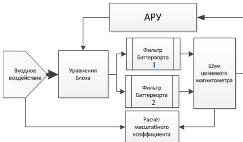
Рис. 2. Схема модели ЯМГ, реализованная в программе MATLAB Simulink, АРУ – автоматическая регулировка усиления
