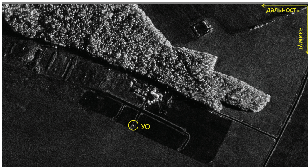
Рис. 7. РЛИ в области УО при T = 6 с (длина апертуры 150 м). Шаг по дальности и азимуту – 0,6 м. Дальность до УО – 3980 м
