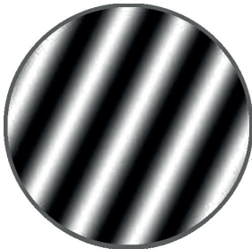
Рис. 6. Интерференционная картина в оптическом интерферометре. Темными и светлыми полосами показаны зоны с минимальным и максимальным количеством света, пришедшим на детектор
