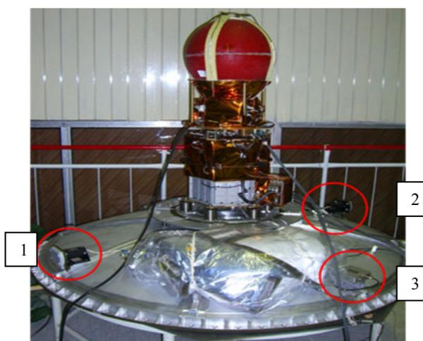
Рис. 3. Размещение элементов аппаратуры SSAU-YES2 на поверхности КА «Фотон-М3»:
