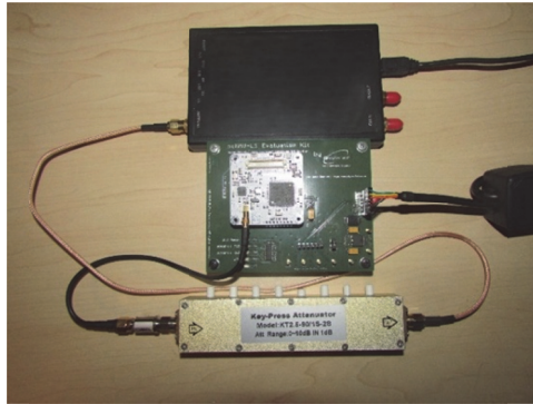
Рис. 4. Испытательная установка piNAV (форм-фактор PocketCube)
