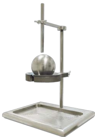
Рисунок 3 – Приспособление для реализации механического удара шариком с рабочим телом диаметром 75 мм
